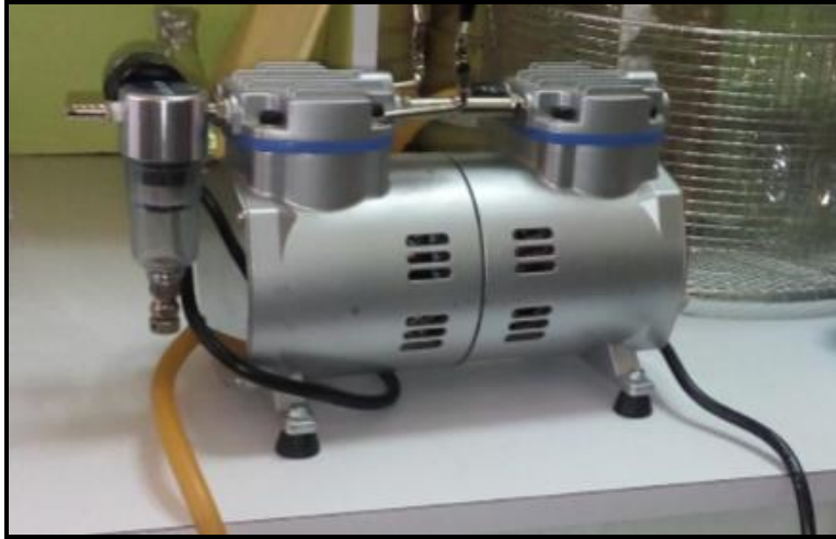
Ilustración 16 Bomba de vacío utilizada en Colpos Fuente: Elaboración propia en COLPOS
