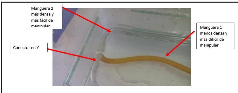
Ilustración 24 Mangueras colocadas dentro del contenedor Fuente: Elaboración propia en ColPos
