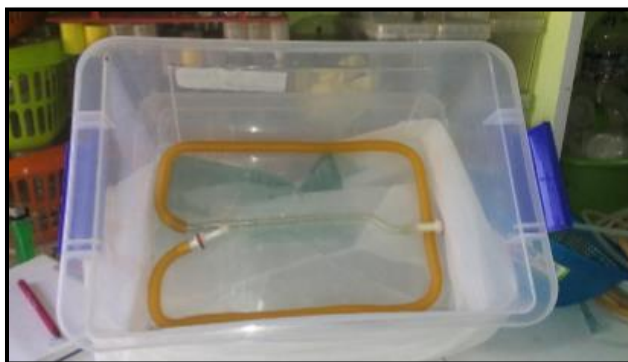
Ilustración 20 Manguera fijada al fondo del contenedor Fuente: Elaboración propia en ColPos
