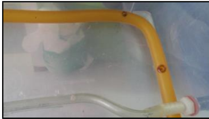
Ilustración 21 Orificios realizados a lo largo de la manguera Fuente: Elaboración propia en ColPos
