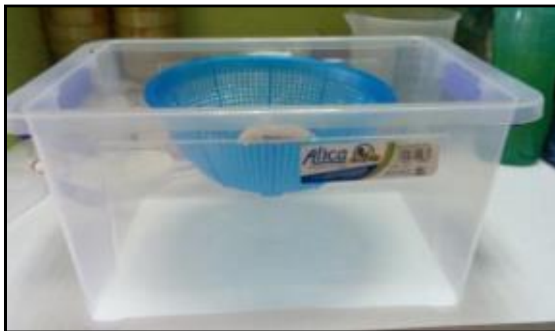
Ilustración 18 Coladera fijada dentro del contenedor de plástico Fuente: Elaboración propia en ColPos
