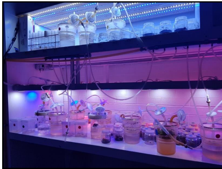
Ilustración 11 Sistema tipo RITA semi automatizado Fuente: Elaboración propia en ColPos
