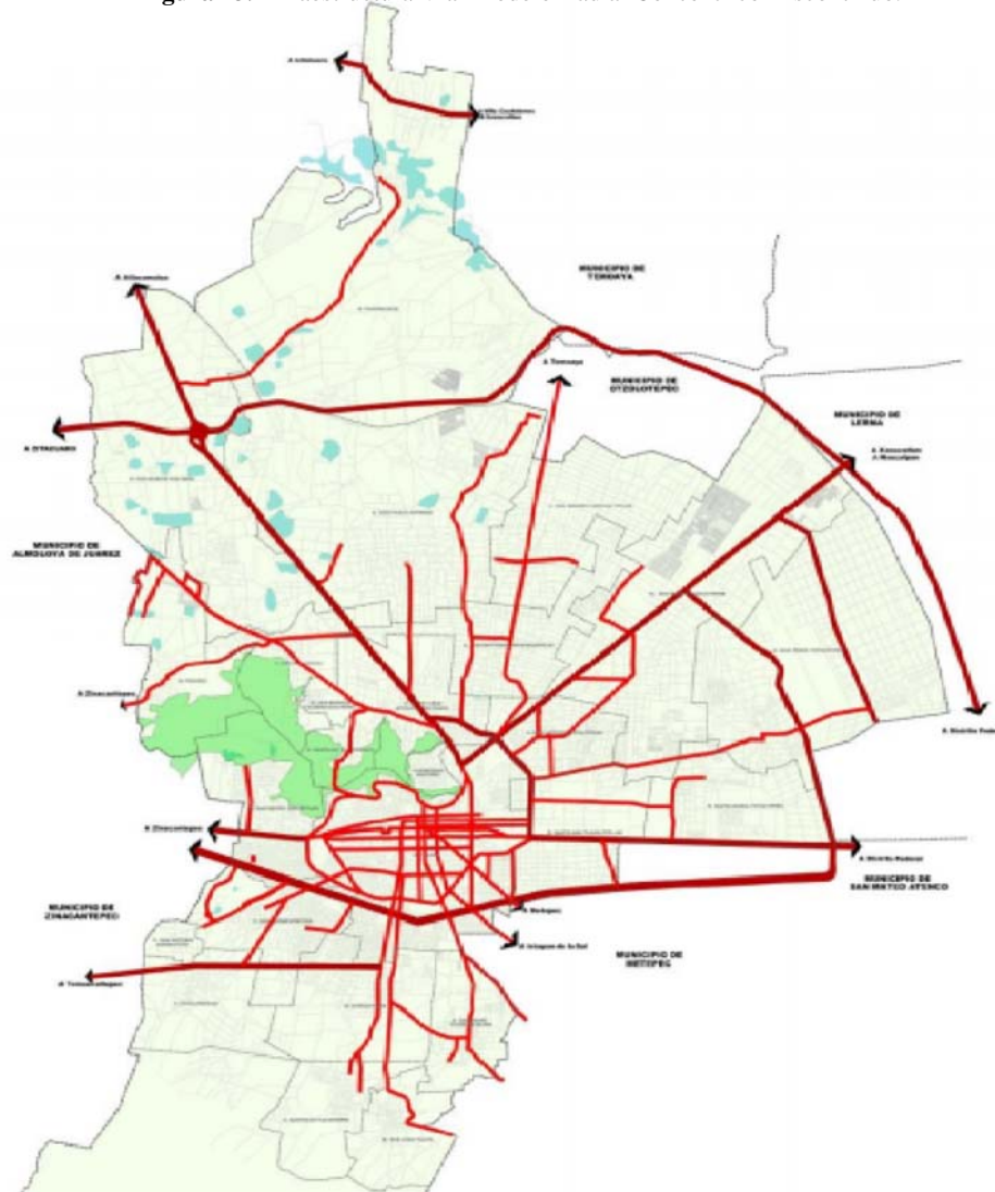
Figura 13. Infraestructura Vial Modelo Radial Concéntrico Discontinuo.
