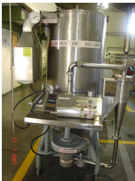
Figura 2.1. Secador por aspersión Nichols/Niro
