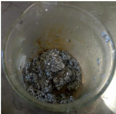
Figura 2 Muestra de aluminio, aceite y polietileno remanente después de una hora de calentamiento
