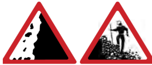
1 Roca suelta o deleznable 2 Suelo inestable
