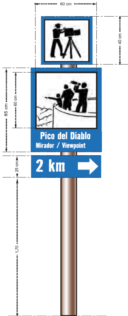
Medidas recomendadas para una señal informativa de carretera. Punto de máxima visión: 1 km
