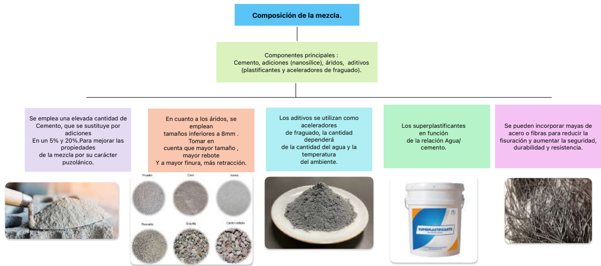
Figura 43: Mezcla concreto impresión 3D de concreto. Basado en (Muñoz, 2023) Fuente: elaboración propia
