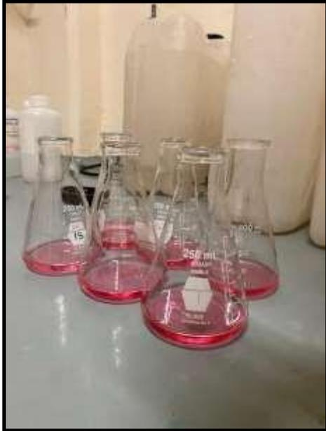
Figura 17. "Ácido Bórico con indicador verde de bromocresol-rojo de metilo."
