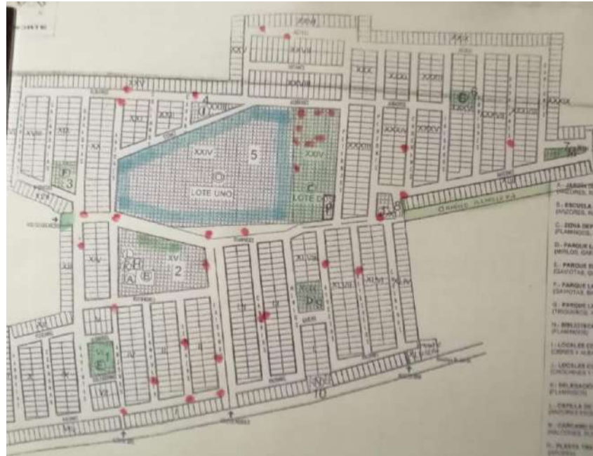
Figura 12 Inventario de luminarias en mal estado
