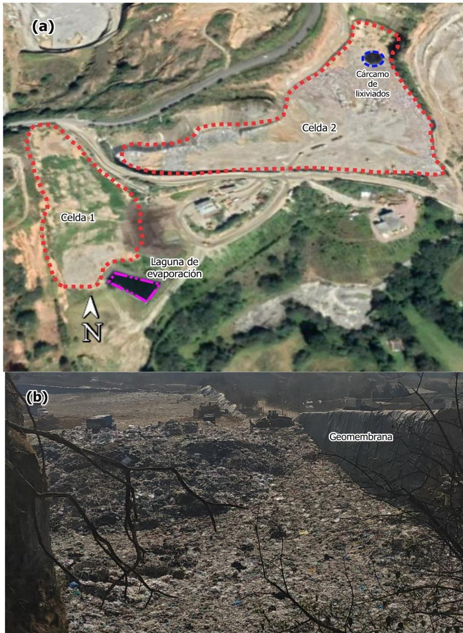
**Figura 4.9** a) Plano de distribución de las celdas del relleno sanitario de Xonacatlán, b) Fotografía de la disposición de la geomembrana en una pared lateral del relleno sanitario, lo que hace suponer que ésta está colocada en toda la celda.
