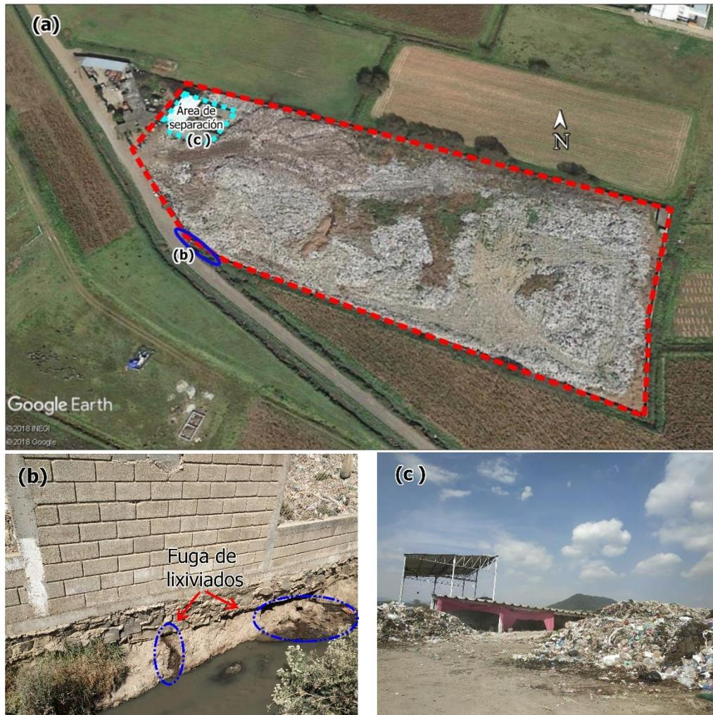
**Figura 4.4.** a) Se muestra la ubicación del área utilizada para la separación de residuos en el vertedero de Capulhuac, así como la ubicación del sitio donde se observó la fuga de lixiviados, b) Se aprecia la filtración de lixiviados a través de las paredes perimetrales del sitio; c) Fotografía del área donde se realiza la separación de PET, cartón y demás residuos que pueden ser reciclados.
