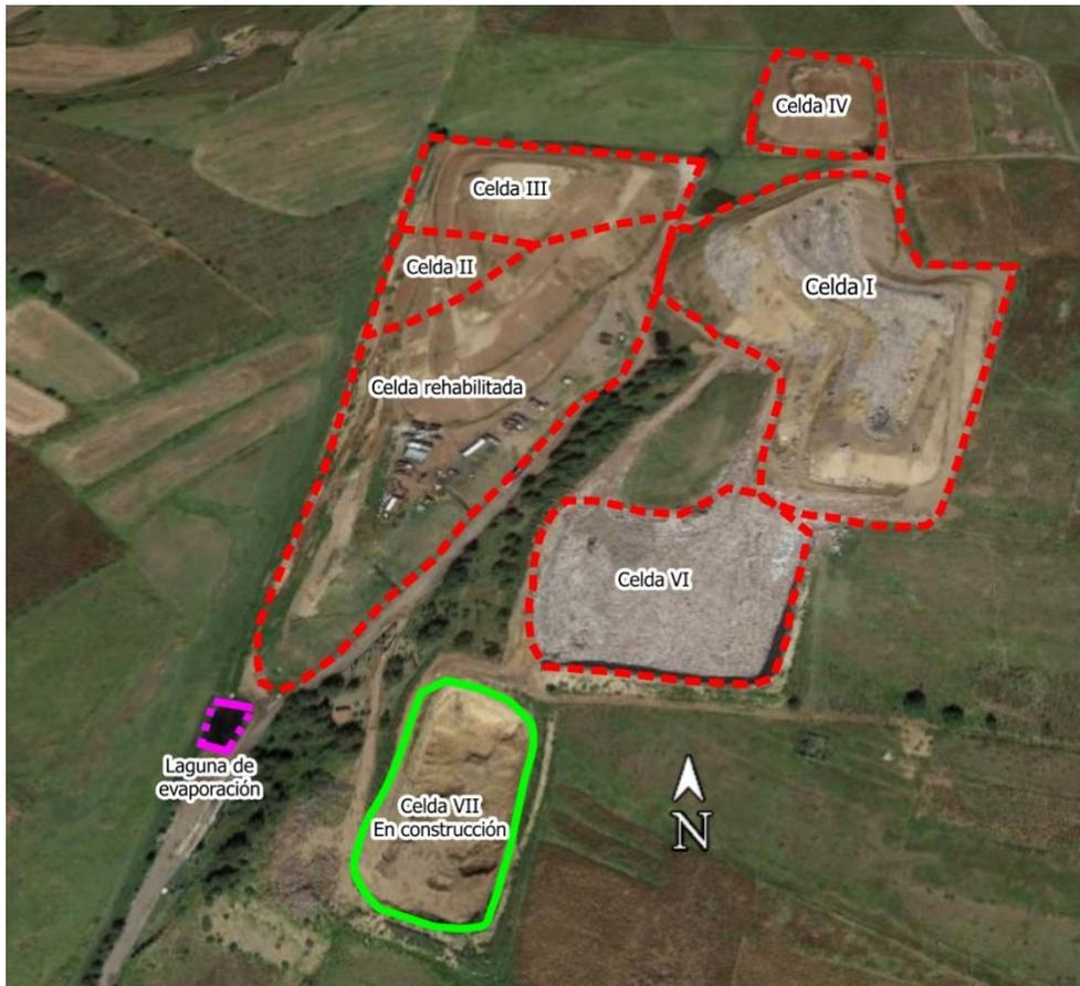
**Figura 4.10** Distribución de las celdas que componen el relleno sanitario de Zinacantepec, es de resaltar que la laguna de evaporación es pequeña para las dimensiones del relleno sanitario.
