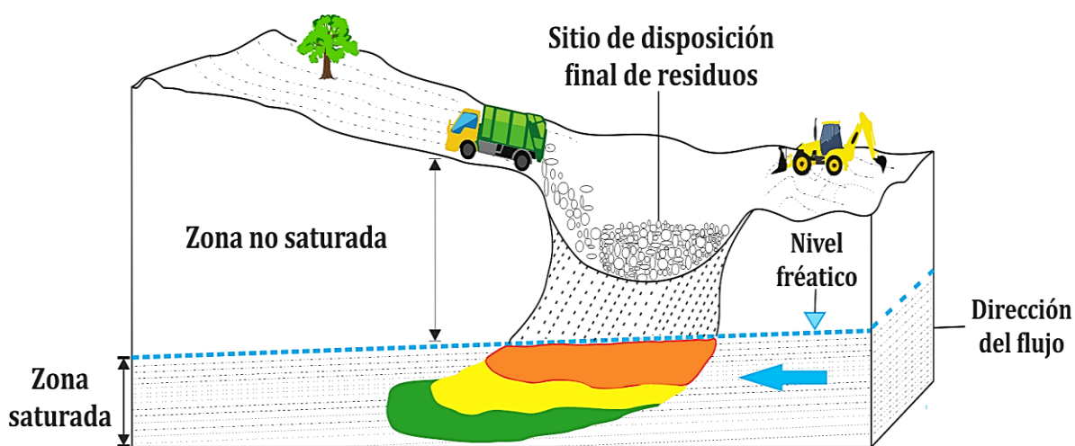
Figura 2.8 Diagrama conceptual de una pluma de contaminación en el agua subterránea derivado de un vertedero (Gillham y Cherry, 1989).
