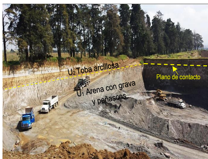
Figura 5.11 Mina de materiales pétreos ubicada a 250 m al suroeste del sitio controlado Calimaya. Se observaron dos unidades litológicas, abajo se tiene un horizonte grueso de arena con grava y peñascos U_1 , y sobreyace un horizonte de toba arcillosa U_2 .
